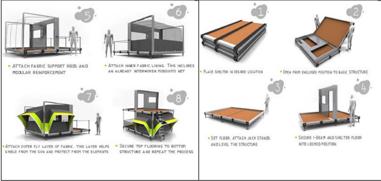
الشكل (6) طريقة نشر الهيكل ومراحل انشاؤه ضمن الموقع ، المصدر: mrmannoticias.blogspot.com
