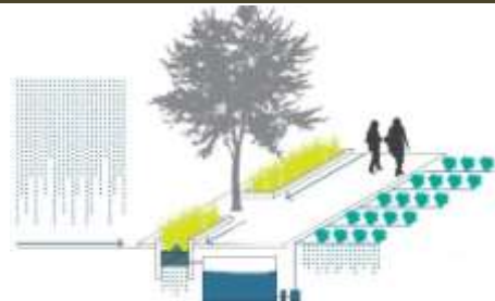
الشكل (16) جمع مياه الامطار من سقف البيت الزجاجي وإعادة استخدامها في ري المحاصيل. المصدر (Gerard, 2011, p.79)
